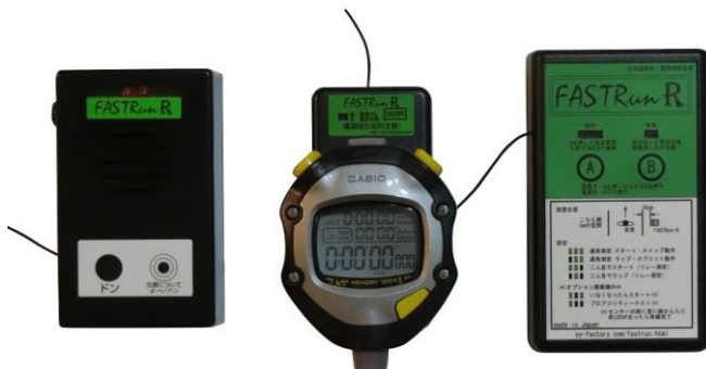
図1:ファストラン R の構成(左からスタートユニット、タイマー、センサーユニット)
