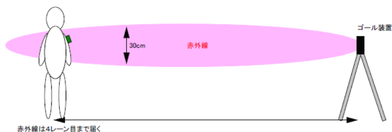
図7 ゴール装置の正しい設置: 上下方向が水平になっている
